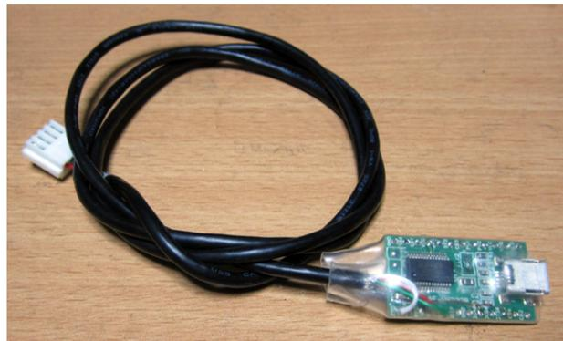
図3 FT232RL モジュール加工例
